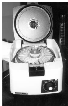
Fig. 1.25. Muestra una centrífuga de tubos capilares, empleada para análisis clínicos.
