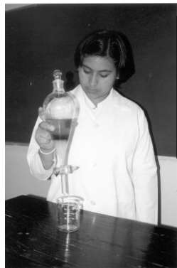
Fig. 1.23 Decantación de una mezcla que contiene agua, aceite y gasolina.
